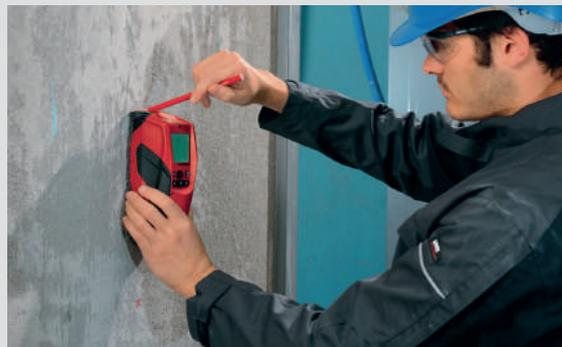
Con queste strumentazioni verranno rilevate la resistenza del calcestruzzo (**SCLEROMETRO**) e l'armatura principale della struttura (**PACOMETRO**).
